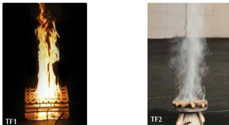
Slika 4.13 Ispitni požari TF1 i TF2
