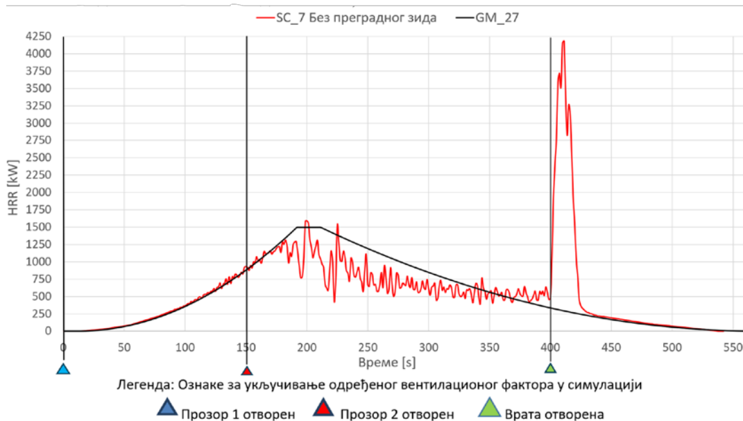
Слика 6.7 Polyethylene_GM 27 - HRR крива и HRR крива ISO 668:2020 HC 9 t, сценарио SC_7 без преградног зида, у условима отварања прозора на А страни модела у 0 s, отварања прозора на Д страни модела у 150 s и отварање врата на Б страни модела у 400 s.
