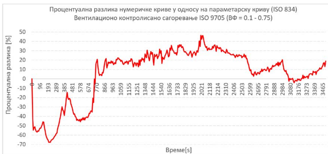
Слика 7.2 Процентуална разлика нумеричке пожарне криве у односу на параметарску пожарну криву (ISO 834), пожар контролисан вентилационим фактором за средњу вредност, ВФ = 0.1 – 0.75
