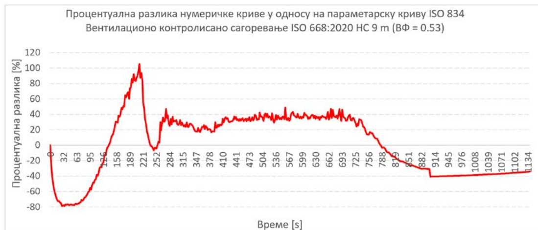
Слика 7.14 Процентуална разлика нумеричке пожарне криве у односу на параметарску пожарну криву (ISO 834), пожар контролисан вентилационим фактором ВФ = 0.53
