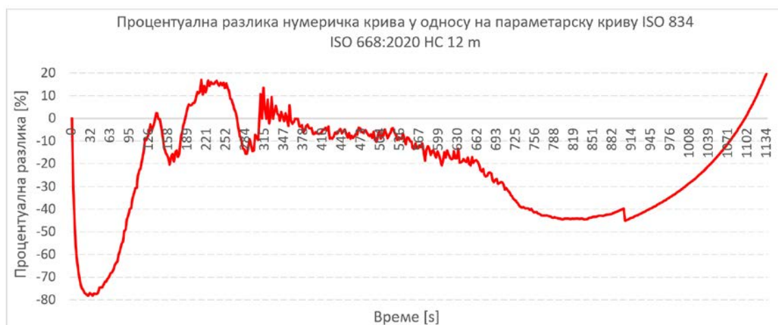
Слика 7.24 Процентуална разлика нумеричке пожарне криве у односу на параметарску пожарну криву, за средњу вредност ВФ = 0.53 - 1
