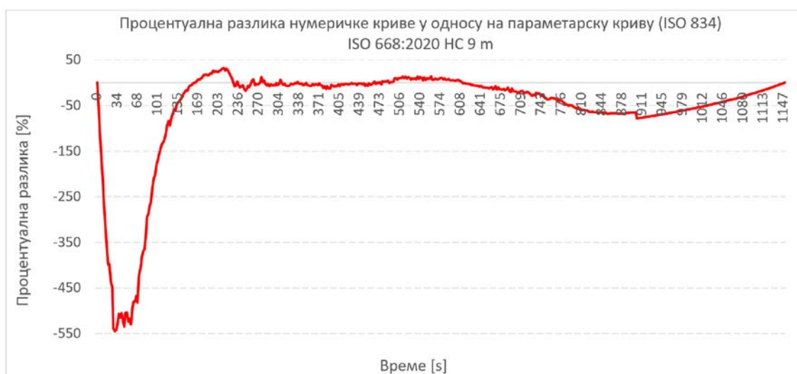
Слика 7.18 Процентуална разлика нумеричке пожарне криве у односу на параметарску пожарну криву (ISO 834), за средњу вредност, ВФ = 0.53 - 1
