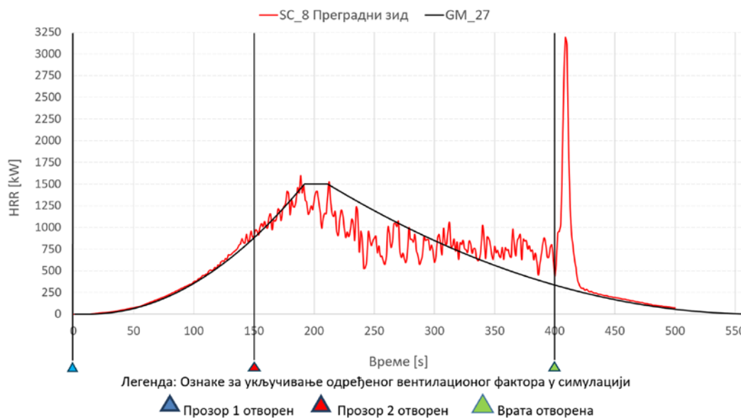
Слика 6.9 Polyethylene_GM 27 - HRR kriva и HRR крива ISO 668:2020 HC 9 m, сценарио SC_8 са преградним зидом, у условима отварања прозора на А страни модела у 0 s, отварања прозора на Д страни модела у 150 s и отварања врата на Б страни модела у 400 s.
