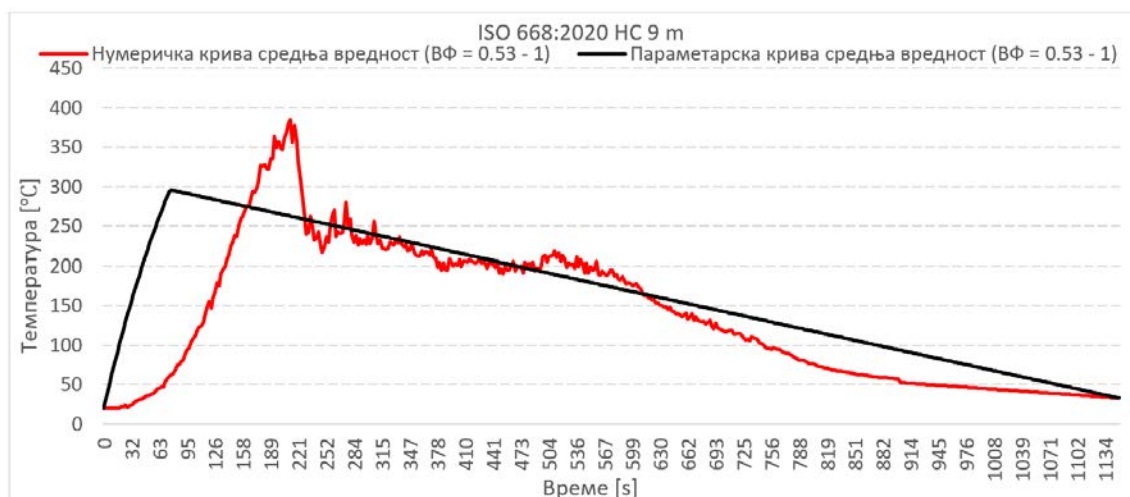
Слика 7.17 Средња вредност нумеричке пожарне криве и параметарске пожарне криве, пожара контролисан вентилационим фактором, ВФ = 0.53 - 1
