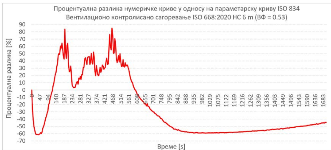
Слика 7.8 Процентуална разлика нумеричке пожарне криве у односу на параметарску пожарну криву (ISO 834), пожар контролисан вентилационим фактором, ВФ = 0.53
